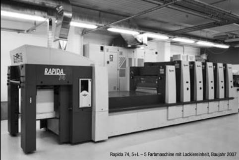
Rapida 74, 5+L - 5 Farbmaschine mit Lackiereinheit, Baujahr 2007
