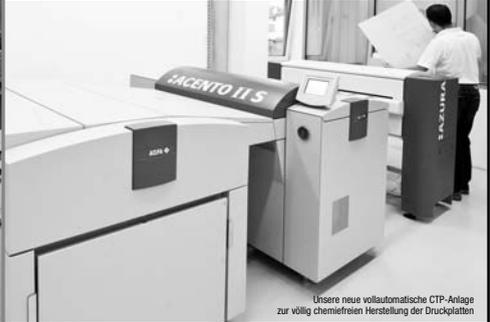
Unsere neue vollautomatische CTP-Anlage zur völlig chemiefreien Herstellung der Druckplatten
